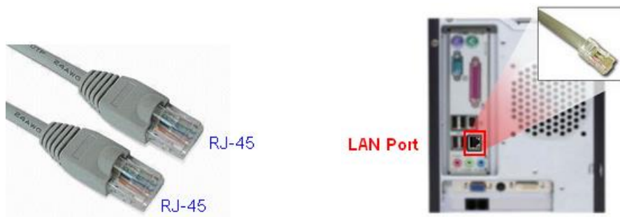
สาย LAN และ LAN Port ของเครื่องคอมพิวเตอร์
